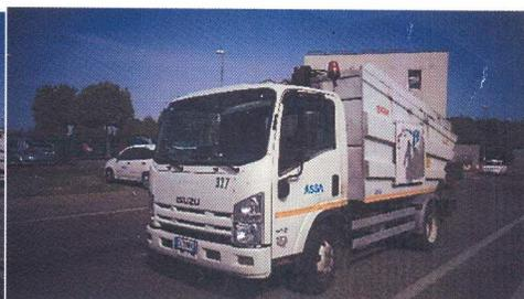
**TELAIO: ISUZU NPR75-L5A cambio automatico**
