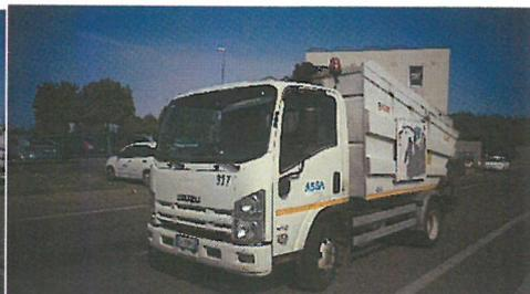
**TELAIO: ISUZU NPR75-L5A cambio automatico**
