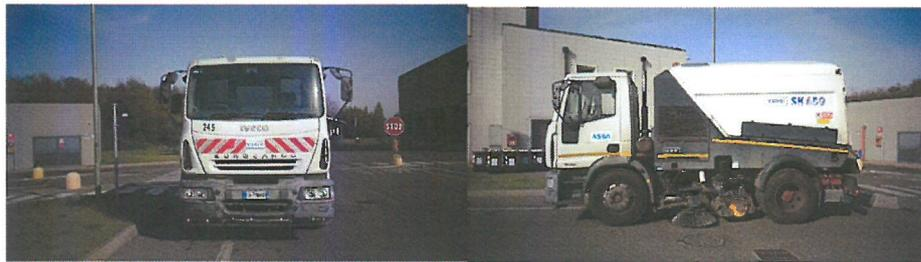
**TELAIO: IVECO 150 - ATTREZZATURA: SPAZZATRICE ASPIRANTE
