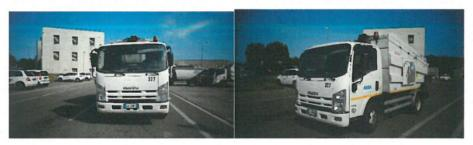
**TELAIO: ISUZU NPR75-L5A cambio automatico**
